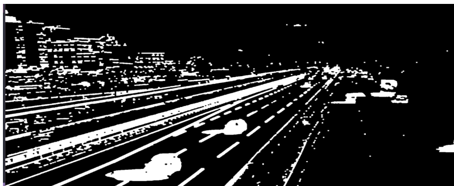
Figura 15 - Programa rodando a escala de cinza para detecção de objetos.
