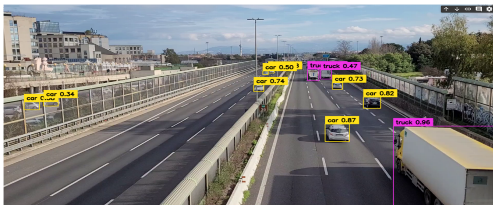
Figura 18 - Detecção com YOLO com funções de correção de erros
