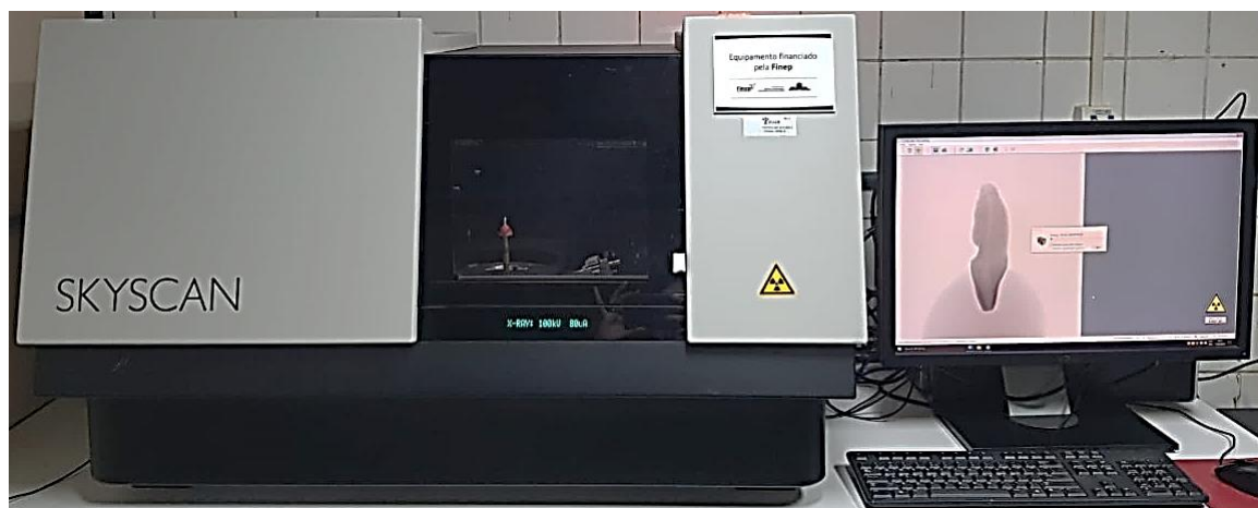
Figura 2. Microtomógrafo SkyScan e Imagem escaneada transferida para computador
