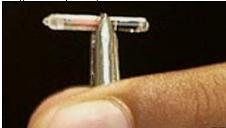
Figura 16 – Pequeno chip RFID utilizado na área da saúde.
