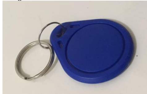
Figura 25 – Tag chaveiro MIFARE S50 utilizada no protótipo.
