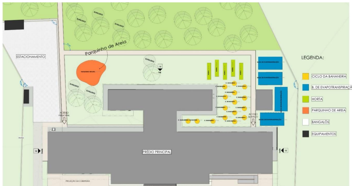
Figura 59: Implantação do círculo da bananeira e das bacias de evapotranspiração.
