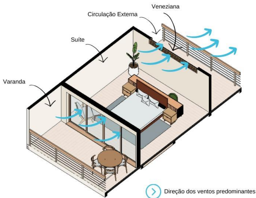
Figura 49: Esquema de ventilação cruzada nas suítes Tipo 1.
