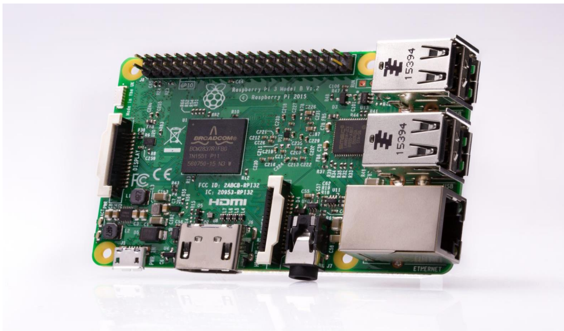
Figura 6 - Raspberry PI 3, modelo B
