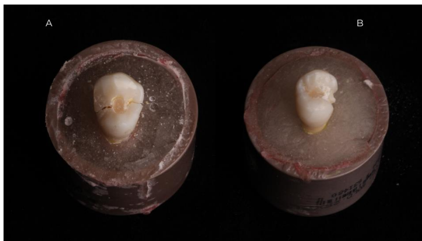
Figura 5. Exemplo de amostra com padrão de fratura desfavorável (A) e favorável (B).
