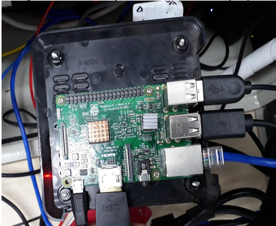
Figura 14: Conexão dos componentes no Microcontrolador Raspebery Pi
