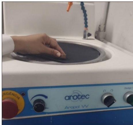
Figura 6. Planificação de espécime, com lixa de óxido de alumínio, em politriz.
