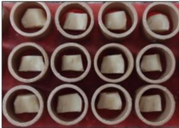
Figura 5. Fragmentos dentais inseridos em cera 7 e posicionados em matriz de PVC, prontos para inclusão em resina acrílica.
