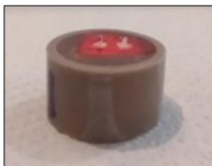
Figura 11. Delimitação da área de 1mm ao redor das interfaces adesivas com auxílio de esmalte cosmético vermelho, para realização do desafio erosivo.
