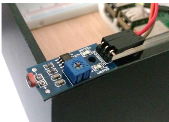
Figura 12 – Sensor de Luminosidade LDR
