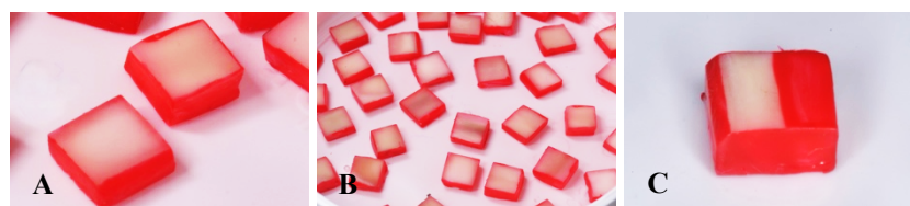
Figura 2. A) Amostras com suas superfícies laterais e fundos recobertas com verniz impermeável de cor vermelha (Colorama). B) Amostras imersas em solução de ácido cítrico a 1%, pH 2,0 por 10 minutos para o processo de pré-erosão. C) Metade da superfície vestibular das amostras protegida com a aplicação de verniz impermeável de cor vermelha. FONTE: Autor (2024).
