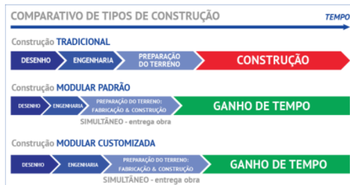
Figura 12: Comparativo entre a construção tradicional e a construção modular.
