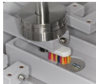
Figura 3.20 - Escova paralela à base dos espécimes.
