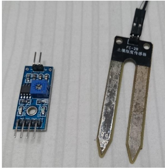
Figura 20 - Sensor de umidade do solo higrômetro
