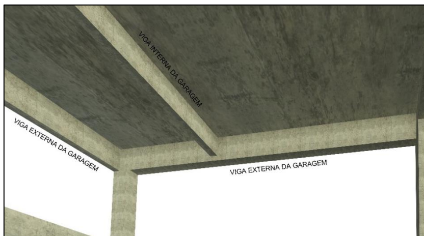
Figura 19 – Detalhe do Rebaixo de Vigas Externas da Garagem
