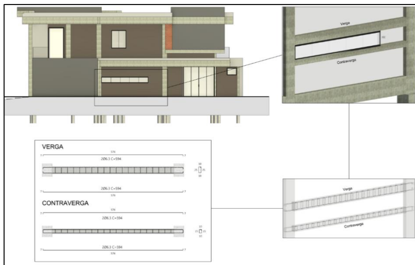
Figura 18 – Detalhe da Armação de Verga e Contra-Verga
