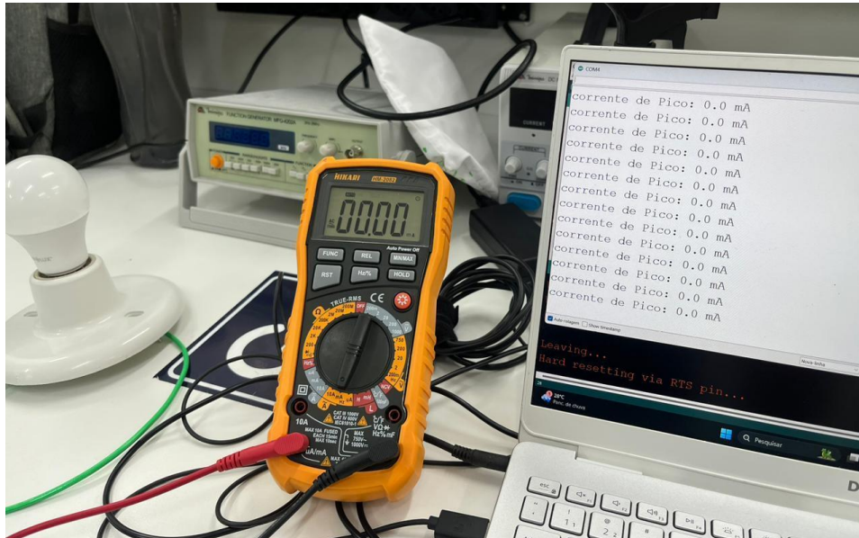
Figura 7: Leitura de corrente elétrica com a lâmpada desligada.
