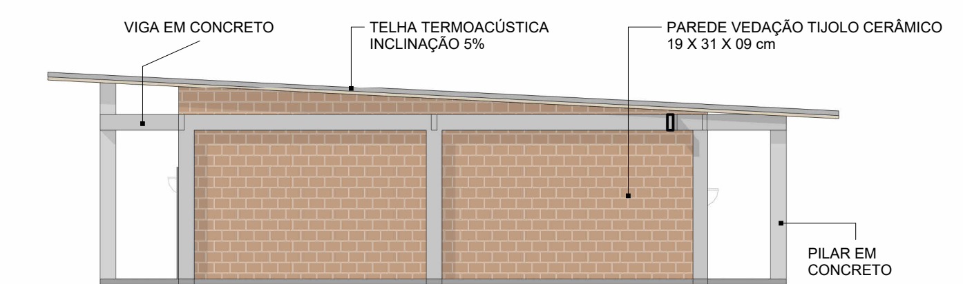
6 FACHADA LATERAL DIREITA ESCALA: 1:100
