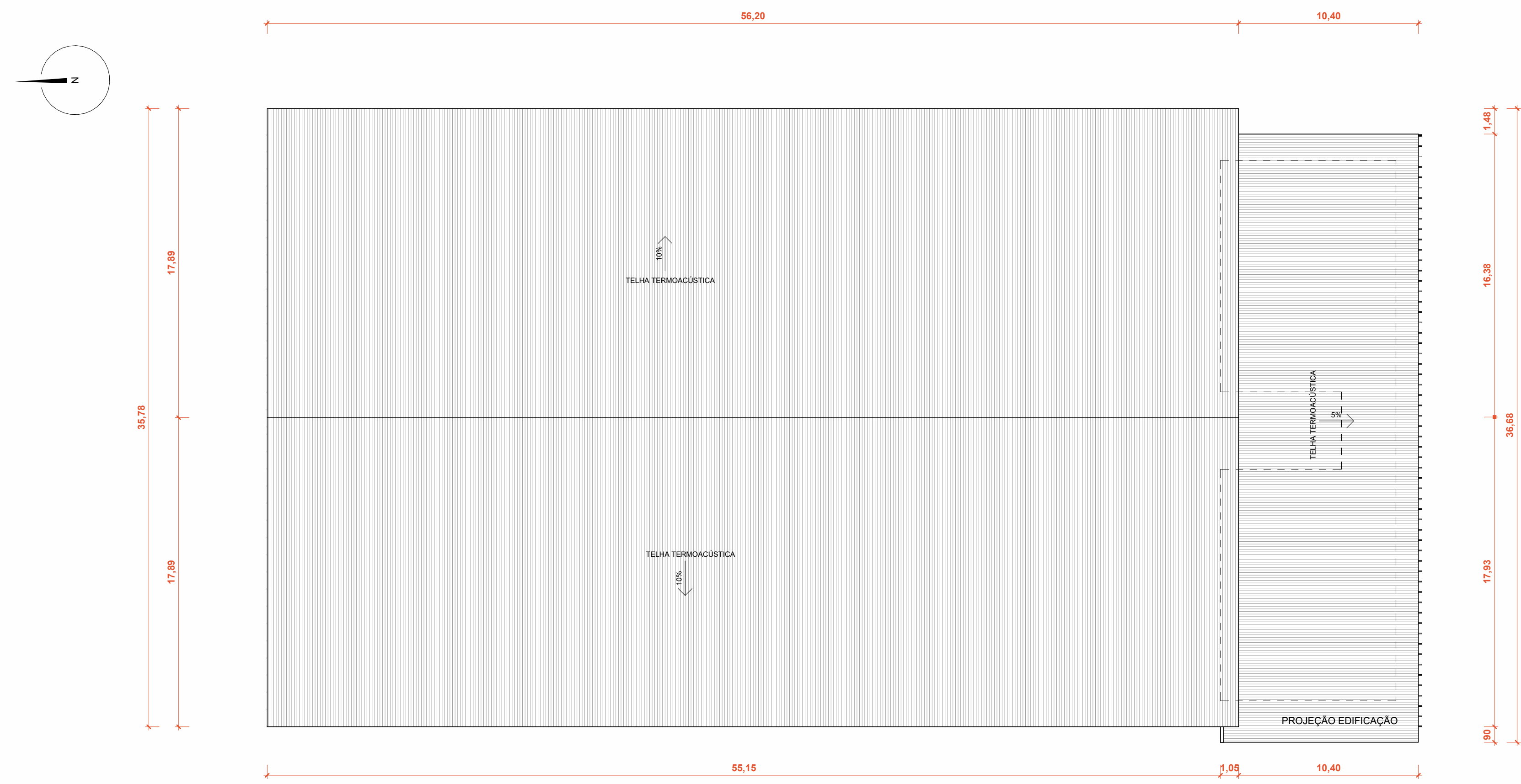
3 PLANTA COBERTURA GINÁSIO POLIESPORTIVO SETOR GINÁSIO ESCALA: 1:200
