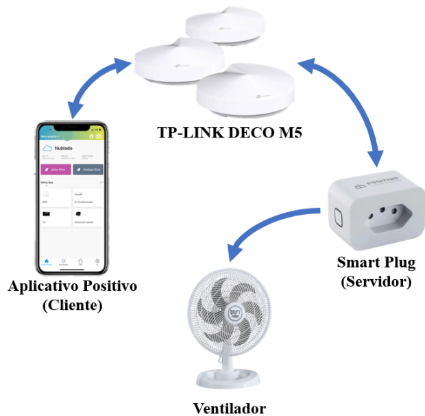
Figura 18 - Aacionamento do Sistema de Tomada Inteligente com o Aplicativo da Positivo
