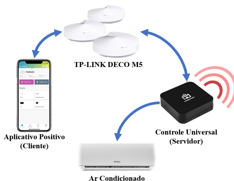
Figura 17 - Acionamento do Sistema de Infravermelho com Aplicativo Positivo
