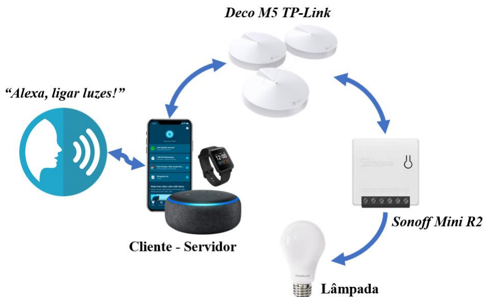
Figura 15 - Acionamento do Sistema de Iluminação
