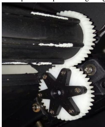
Figura 20: Eixo superior acoplado à engrenagem de tração
