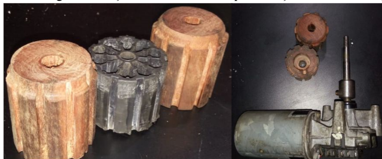
Figura 6 - Peças feitas em madeira para fixação dos eixos de aço
