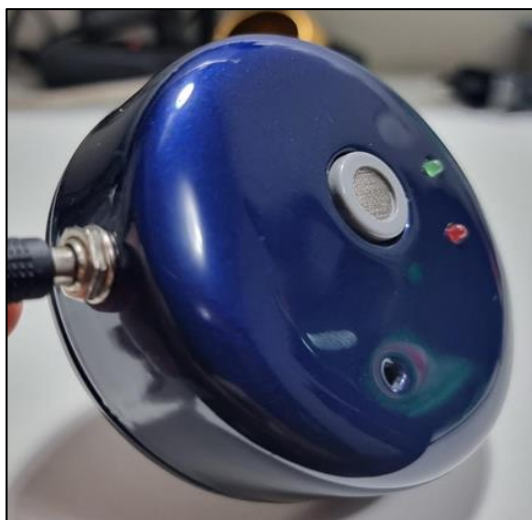
Figura 25 – Versão final da placa de sensor com case impresso.
