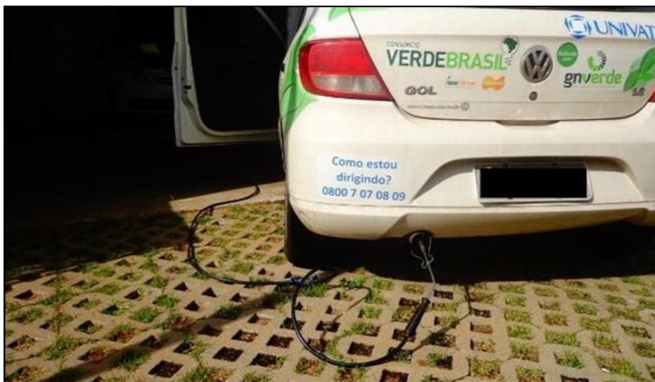
Figura 4 – Ilustração da medição do monóxido de carbono em veículos automotores.
