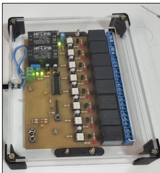
Figura 29 – Versão final da placa de acionadores com case impresso.
