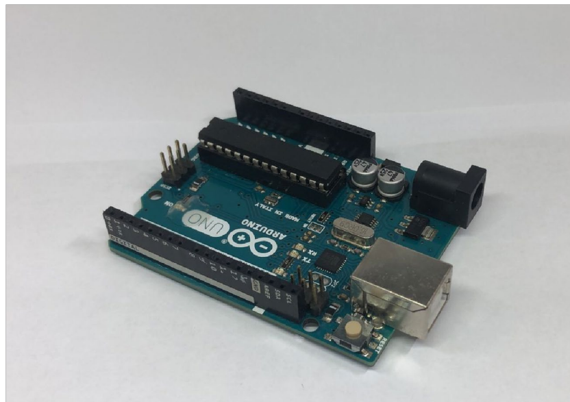
Figura 10. Arduino Uno usado para controle dos componentes e módulos para automação do colete.
