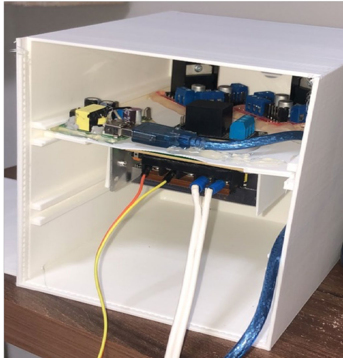
Figura 19. Gabinete feito para acomodar os circuitos.
