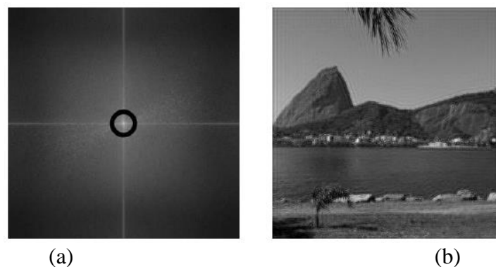
Figura 27: Espectro discreto da imagem digital filtrado por um passa-bandas (a) e imagem reconstruída e filtrada, onde se manteve os detalhes e o intervalo fechado das frequências (b).
