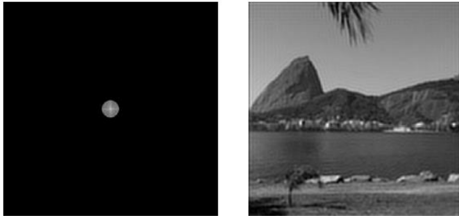
Figura 25: Espectro discreto de potencias da imagem filtrada por um passa-baixas ideal (a) e a imagem reconstruída, onde é possível notar-se a suavização das bordas e a consequente perda de detalhes finos (b).
