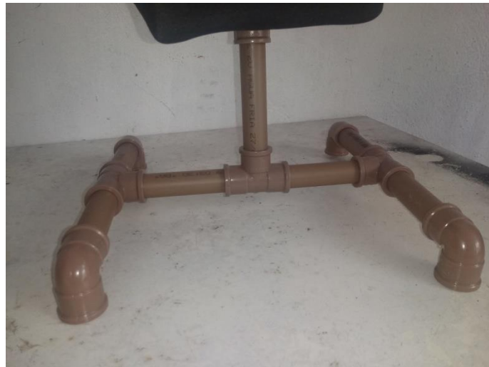
Figura 55: Base feita por canos PVC. Fonte: Autores.
