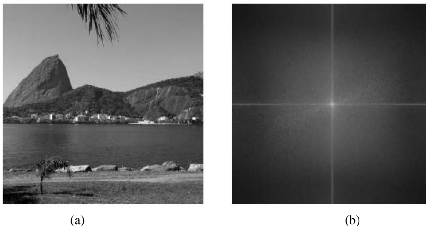
Figura 24: Imagem original (a), e espectro discreto de potência localizado no centro da imagem (b). Fonte: Albuquerque; Persechino, 2015.
