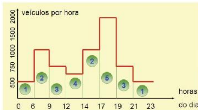
Figura 1: Representação de quantidade de veículos por hora x horas do dia Fonte: Moreno, Mamade e Filho, 2014.
