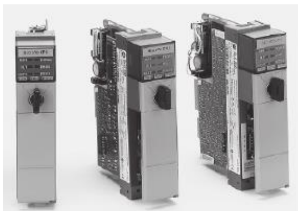
Figura 32: Módulo de um processador para CLP. Fonte: Petruzelli, 2014.
