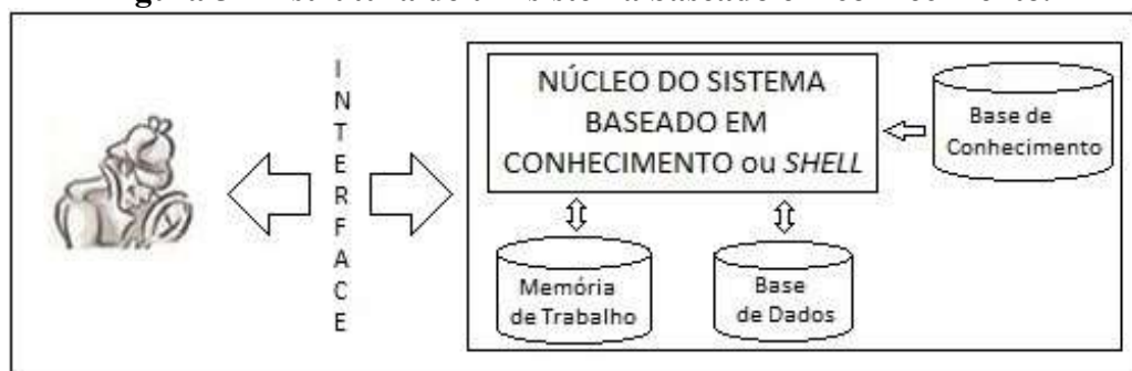
Figura 5 – Estrutura de um sistema baseado em conhecimento.
